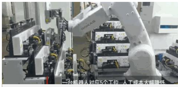
Router inspection 一台机器人对应5个工位 人工成本大幅降低
